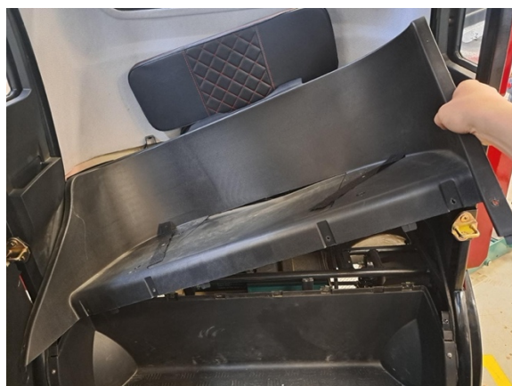
Nosta takaistuimen runko osa pois.
