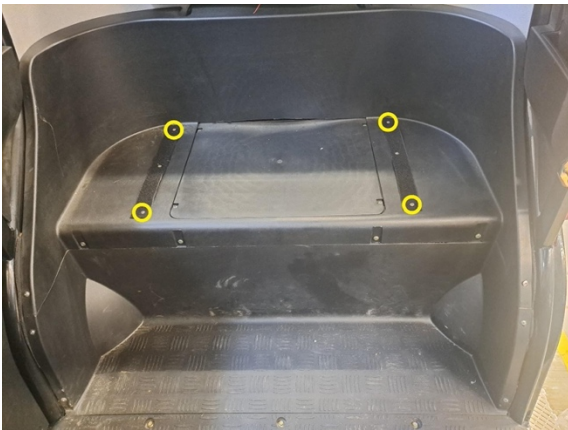
Irrota velcro tarranauhojen reunimmaisiet kiinnitysruuvit. (ristipäämeisseli ph2).
