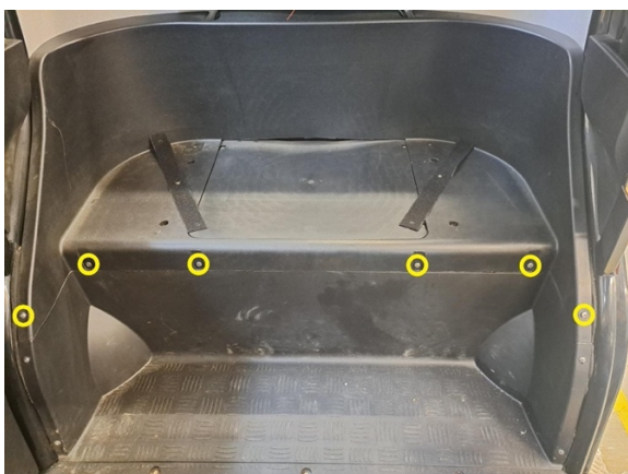
Irrota takaistuimen rungon kiinnitysruuvit. (ristipäämeisseli ph2).
