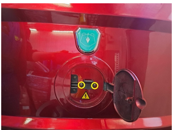
Irrota latausportin kiinnitysruuvit. (ristipäämeisseli ph2).
