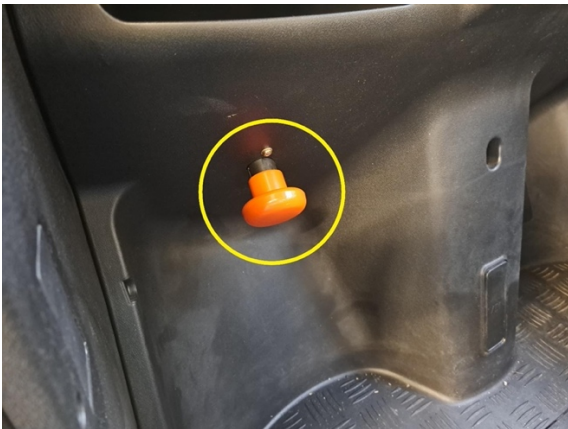
Paina päävirtakyttin kiinni. (tarrakiinnitys).
