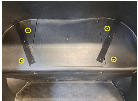
Käännä velcon tarranauhat pois tieltä. Irrota tarranauhojen alta paljastuvat kiinnitysruuvit. (hylsy 8 mm).
